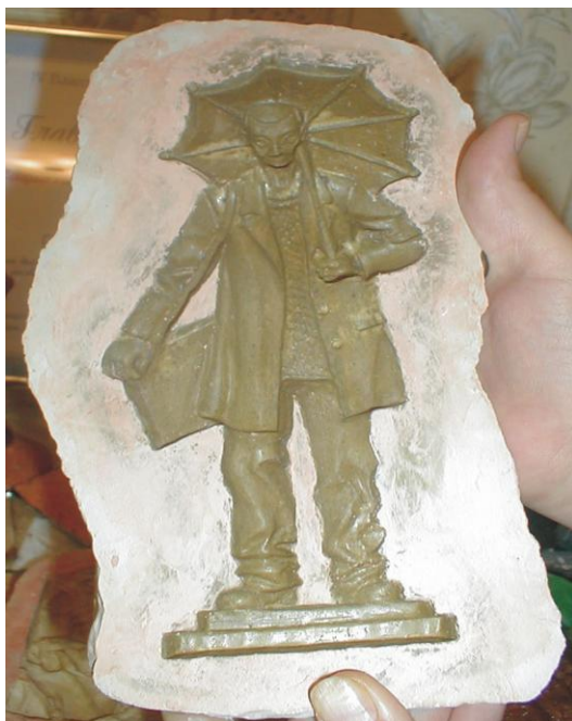
Фото 12. Гипсовая отливка-матрица после нанесения олифы
