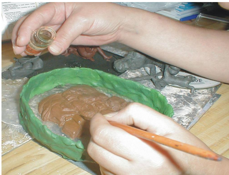
Фото 11. Смазывание модели машинным маслом
