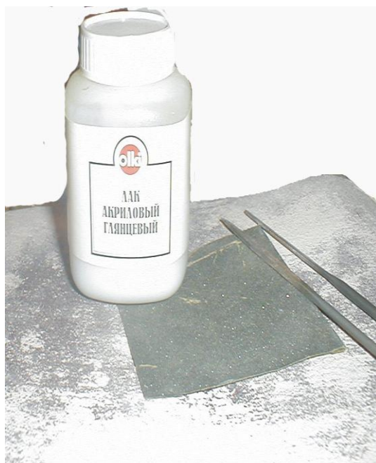
Фото 13. Инструменты для финишной обработки пластикового оттиска
