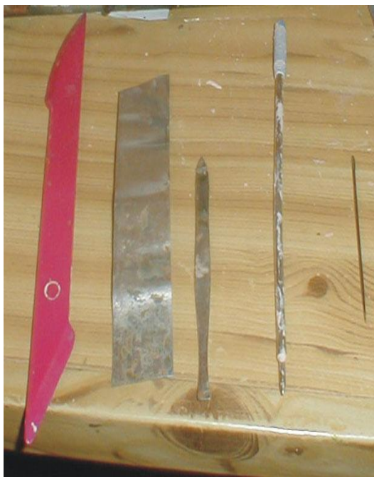
Фото 9. Инструменты для работы с пластилиновой моделью и отливкой
