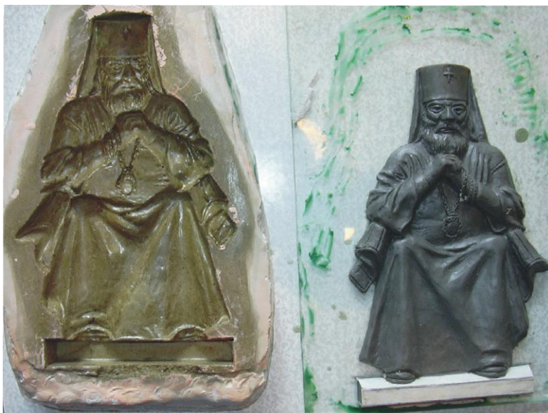
Фото 3. Пластилиновая модель и отливка-матрица
